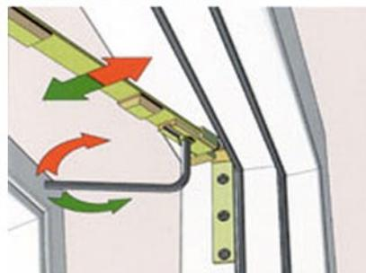
Under beslaget mot øvre hengsle finnes justeringsskruer for øvre hjørne på hengslesiden.
